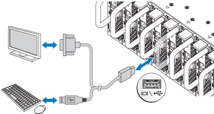
系统正面的连接器上有一个图标，指示要插入的电缆。连接键盘、鼠标或显示器（可选）。
