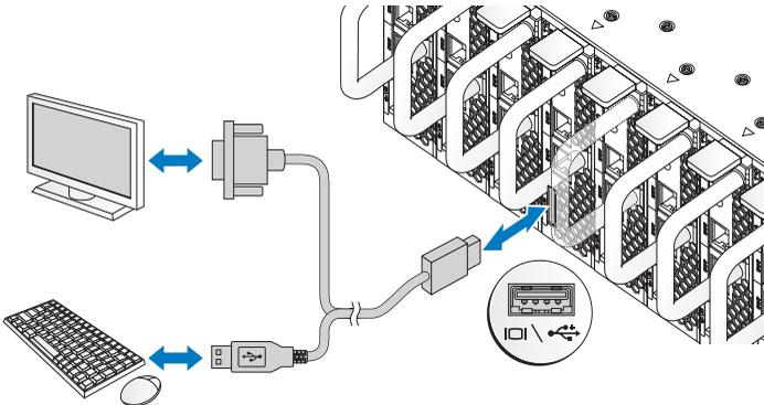
시스템 전면의 커넥터에는 각 커넥터에 연결될 케이블을 표시하는 아이콘이 있습니다. 키보드, 마우스 또는 모니터(선택 사양)를 연결합니다.
