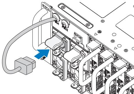
**CATATAN:** Konfigurasi yang benar dari kabel daya AC casing integral ke soket unit pencatu daya (PSU) diperlihatkan dalam ilustrasi berikut ini.
